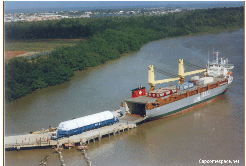
Port de Pariacabo : déchargement d'un segment de lanceur.
