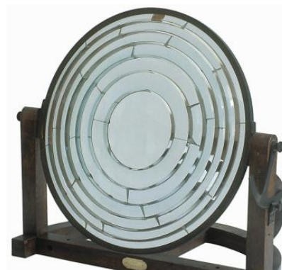
Lentille à échelons de Fresnel réalisée par Jean-Baptiste Soleil 1826 © Collections Ecole polytechnique
