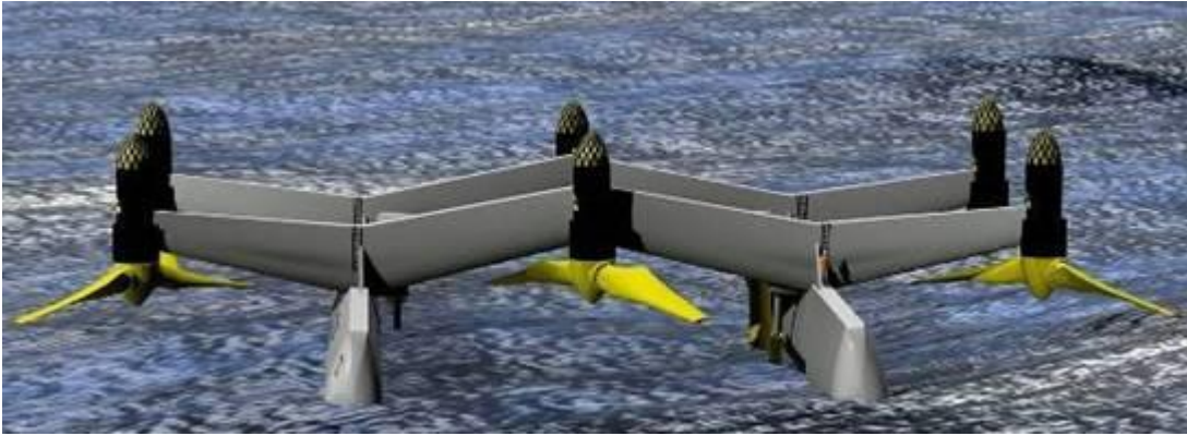
a) Hydrolienne en position d'entretien
