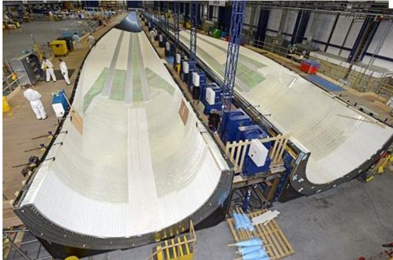
Figure III-7: Moules (étuis) pour la fabrication de pales d'éoliennes en composites de 80m de long utilisés par la compagnie Vesta [Ves 13]
